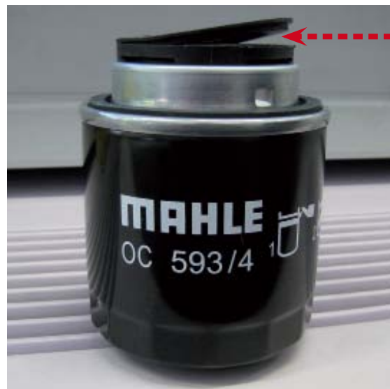
Junta del mecanismo anti-drenado, levantada ligeramente del sujetador, únicamente para referencia.
